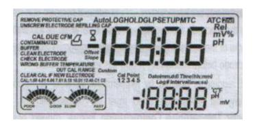
기기는 주요 LCD에는 날짜가 보이고 보조 LCD에는 깜박이는 "Remove protective cap(보호캡 제거)"와 "Unscrew electrode refilling cap(전극 보충캡 열기)"메시지와 함께 시간이 표시될 것이다.
