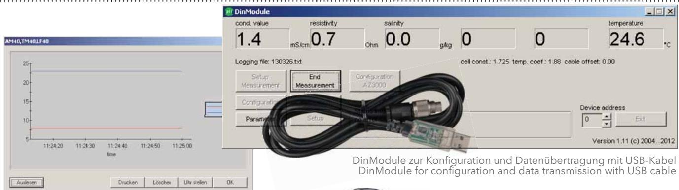
DinModule zur Konfiguration und Datenübertragung mit USB-Kabel
