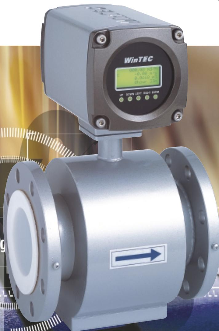
WTM1000 Series는 Electro Magnetic Flow Meter로 유체가 흐르는 배관에 Faraday 법칙을 이용하여 자기장을 형성하고 그 자장에 유체가 흐르면 기전력이 발생한다는 Fleming의 오른손 법칙의 원리를 이용하여 만든 유량계 측기를 전자유량계라고 한다.
