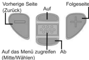
Drücken Sie die Taste (+), um in einem mehrseitigen Menü die Seiten zu wechseln.
