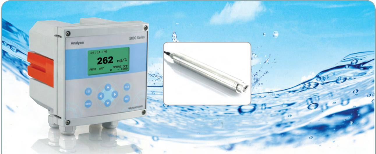
MC-5000 활성슬러지농도 ( Mixed Liquor Suspended Solid) / SC-5000 부유물농도(Suspended Solid) 측정기는 0~20,000mg/L, 0~10mg/L, 0~100mg/L, 0~1000mg/L 까지의 광범위한 부유물질을 임의 설정하여 측정을 가능하게 합니다. 산란광 또는 투과 흡수광 원리에 기초한 센서는 세정장치가 부착되어 있어 표면 세정을 자유롭게 할 수 있고 유지, 관리가 용이한 구조로 설계되었습니다.
