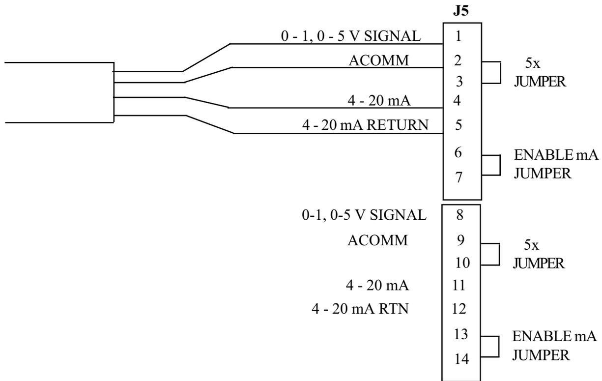
FIG. 2.10 RECORDER CABLE
