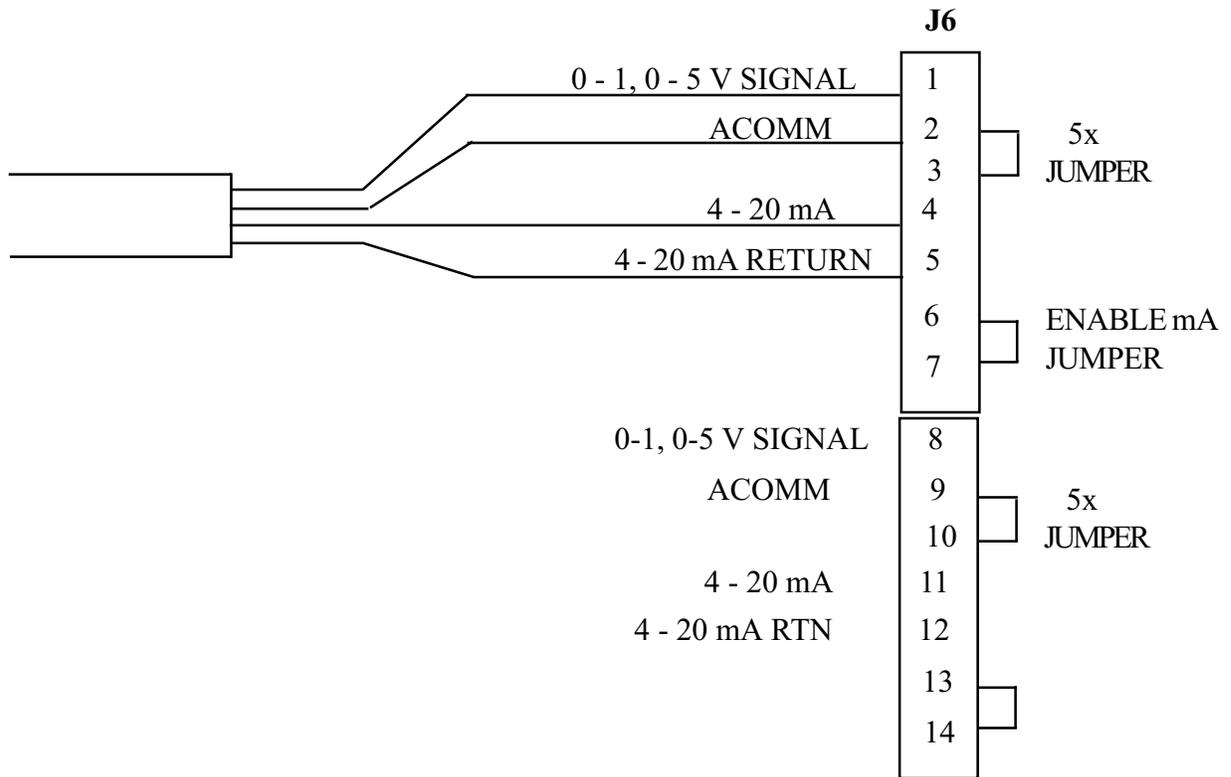
FIG. 2.11 - RECORDER CABLE
