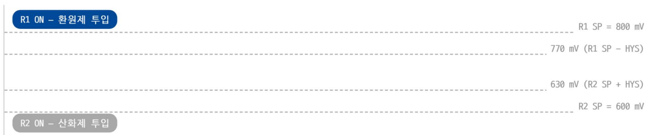
그림 A1 - 히스테리시스 동작 다이어그램
