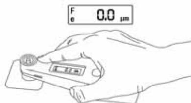
0점 조정 후 계기와 함께 제공되는 표준판을 측정하게 되면 그림과 같이 0 μm 이 표시되는 것을 확인 할 수 있습니다. 이로써 사용자의 임의 0점 조정은 완료가 되었습니다. 측정을 원하는 샘플을 측정합니다.
