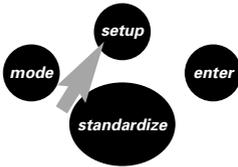
1. Um einen zuvor eingegebenen mV-Offset zu löschen und zum absoluten Millivolt-Modus zurückzukehren, drücken Sie die **Setup**-Taste. Im Display wird nun ein blinkendes *Clear*-Symbol und der aktuelle relative mV-Offset angezeigt.
