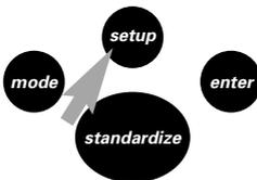
1. Betätigen Sie die **Setup**-Taste, das Messgerät zeigt ein blinkendes *Clear*-Symbol an. *Führen Sie diesen Schritt nur dann durch, wenn Sie alle eingegebenen Puffer löschen möchten.* Drücken Sie die **Enter**-Taste, um alle bestehenden Puffer zu löschen. Das Messgerät löscht daraufhin alle Puffer und kehrt wieder zum Messbildschirm zurück.
