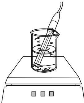
7. Als nächstes führt das Messgerät einen Elektrodentest durch. Im Display werden der Zustand der Elektrode sowie die Steilheit der Elektrode in % angezeigt.
