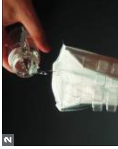
샘플을 Quanti-Tray® (1-200 측정용) 또는 Quanti-Tray®/2000(1-2,419 측정용)에 넣는다
