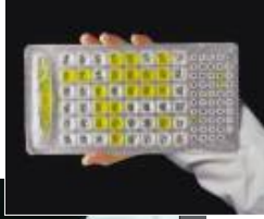
Quanti-Tray®/2000 결과 판독 노란색 웰 -총대장균 양성 노란색/황색 -대장균 양성 MPN표 참조
