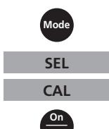
Premendo il tasto [MODE] viene attivata la regolazione del produttore.
