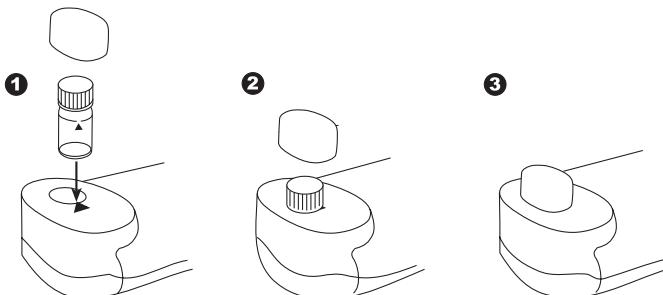
4. La mesure doit être effectuée lorsque le couvercle de la cuvette est fermé.
