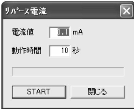
선택을 하면, 그림85와 같이 화면에 표시됩니다. 폐액을 폐액병으로 추출한 후, 세정액(증류수)을 주입합니다. 교반 튜브를 셀에 삽입하고, 전류 값을 설정합니다. START를 클릭하고, 셀, 가스켓 내부, 교반 튜브를 세정합니다. 그 다음 폐액을 제거하고 탈지면을 붙인 면봉 등으로 내부를 깨끗이 닦습니다.
