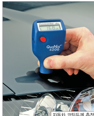
자동차 코팅두께 측정
