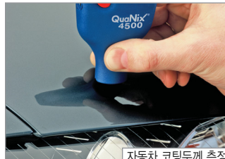
자동차 코팅두께 측정
