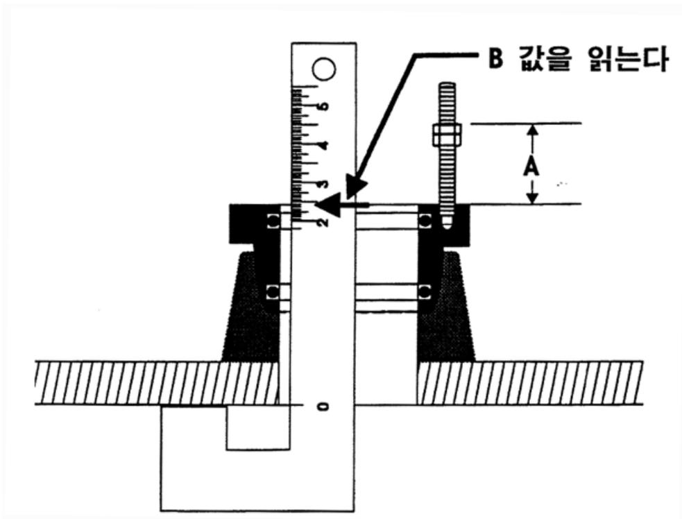
① 센서와 같이 제공되는 삽입 깊이 측정용 자를 사용하십시오. 파이프 위쪽내벽으로부터 어댑터 위쪽면까지의 거리(B)를 측정합니다.
